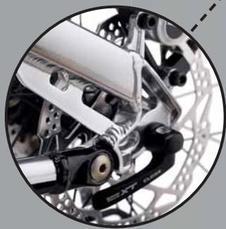
Der Straight Rahmen ist ein so genannter 4-Gelenker. Diese Ansteuerung des Dämpfers ermöglicht, dass der Fahrer im Fahrbetrieb keinen Pedalrückschlag erleidet und ein nahezu einflussneutrales Fahren gewährleistet ist.
