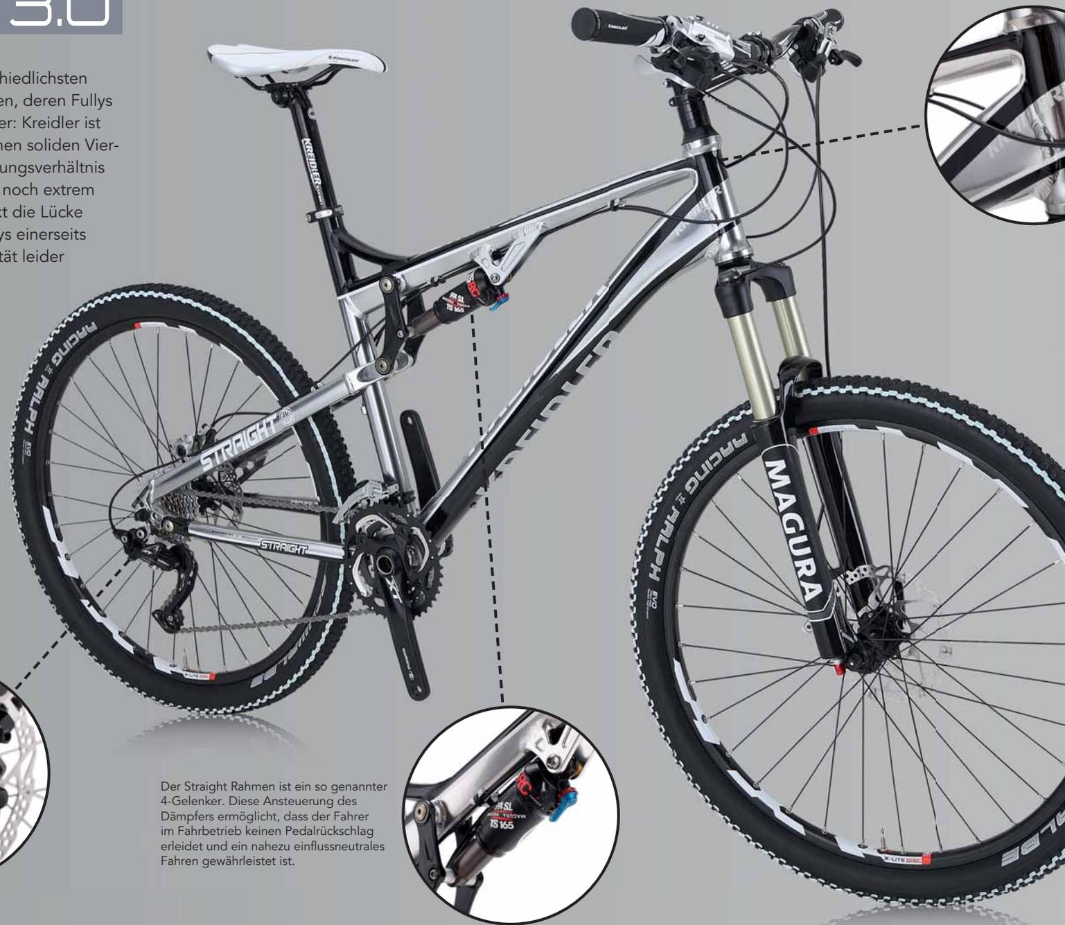
Das Unterrohr ist zum Steuerrohr mit Hydroforming bearbeitet. Das ist nicht nur leicht und steif, es sieht auch noch verdammt gut aus!
