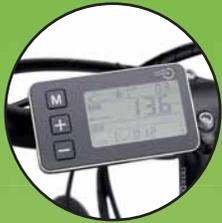
LCD Display | Funktionen: Gesamtkilometer, Tageskilometer, max. Geschwindigkeit, Durchschnittsgeschwindigkeit | 5 Unterstützungsmodi frei wählbar
